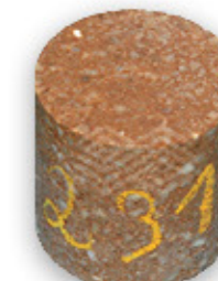
Магнезиальный кирпич с технологией «HR» после 600 часов в паровой камере
