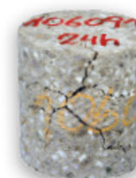
Магнезиальный кирпич, не прошедший специальную обработку, после 24 часов воздействия паром
