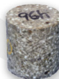
Магнезиальный кирпич, прошедший специальную обработку «R1», после 96 часов воздействия паром
