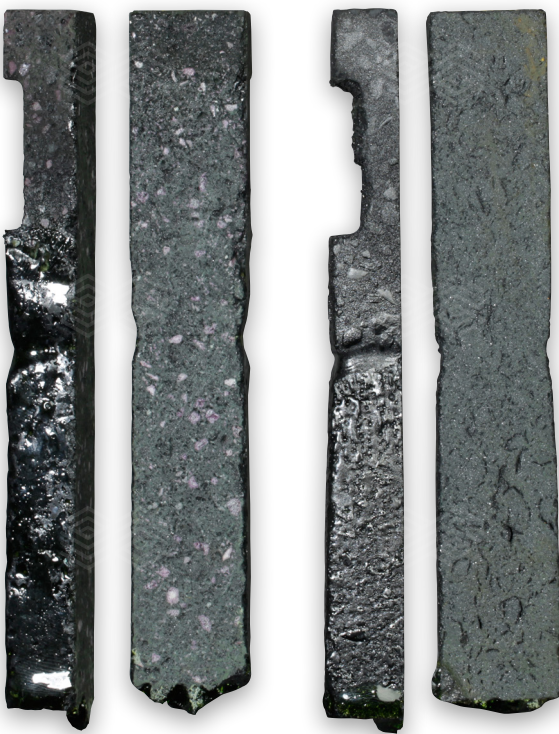
Korrosion von DURITAL CR55ZPBL im Vergleich zu isostatisch gepresstem Chromoxid / Corrosion of DURITAL CR55ZPBL compared to isostatically pressed chromium oxide
