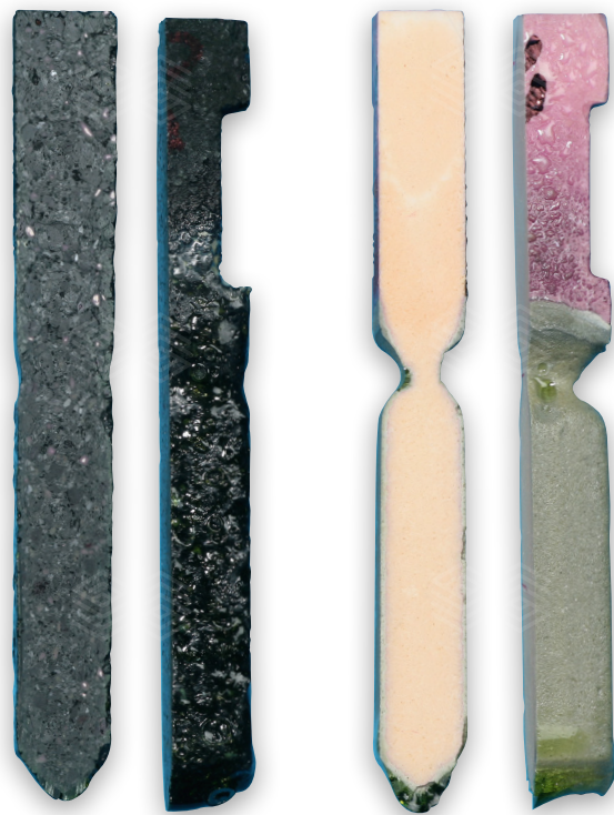
Korrosion von DURITAL CR5OZPNBL im Vergleich zu schmelzgeggossenem AZS / Corrosion of DURITAL CR5OZPNBL compared to fused cast AZS
