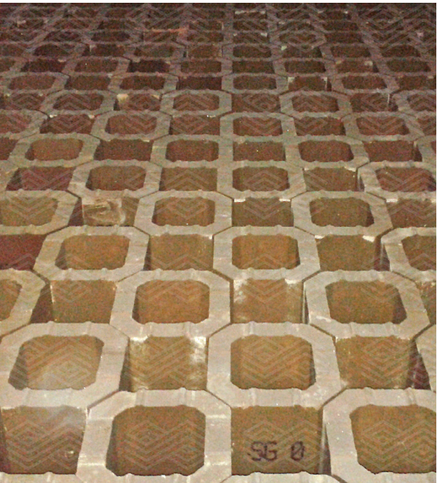
Oberste Lage mit Zirkonmullit (DURITAL AZ58), wenn Glasstaub im Abgas überwiegt Top layer with zirconia mullite (DURITAL AZ58) for fine cullet dominating the waste gas
